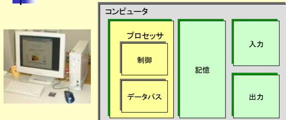
プロセッサは記憶装置から命令とデータを取り出す。入力装置はデータを記憶装置に書き込む。出力装置は記憶装置からデータを読みだす。制御装置は、データバス、記憶装置、入力装置、そして出力装置の動作を指定する信号を送る。
