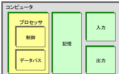
プロセッサは記憶装置から命令とデータを取り出す。入力装置はデータを記憶装置に書き込む。出力装置は記憶装置からデータを読みだす。制御装置は、データバス、記憶装置、入力装置、そして出力装置の動作を指定する信号を送る。
