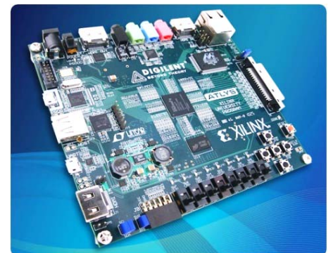
利用するFPGA評価ボード Digilent Atlys Spartan-6 (XC6LX45)
