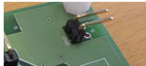
裏面にはんだ付け
