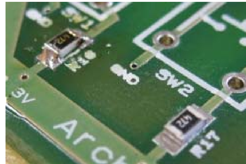
奥のチップ抵抗(R18)のはんだ付けをしたところ. 手前(R17)は固定したところ.
