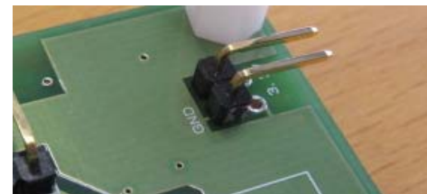
裏面にはんだ付け
