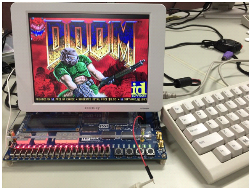
図 2.10: FPGA で実現された計算機で FreeDOS 1.1 を起動し，DOOM をプレイする様子
