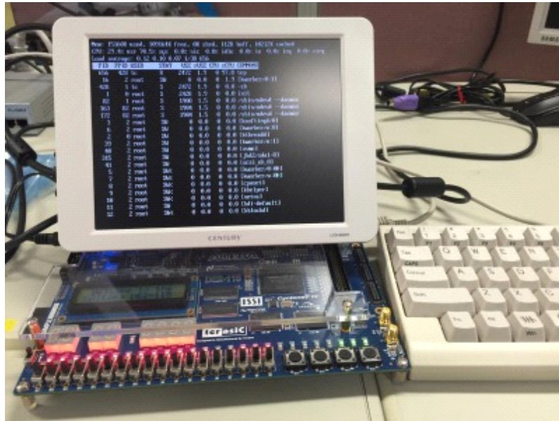
図 2.9: FPGA で実現された計算機での Linux (Tiny Core 5.3) の起動の様子
