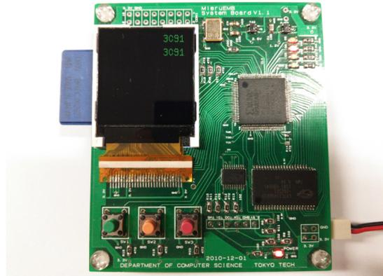
図 4.1 MieruEMB FPGA ボード
